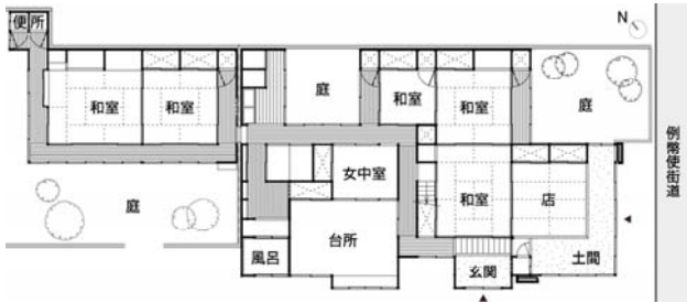
図 12 W家住宅 (泉町) 平面図 縮尺 1/400
